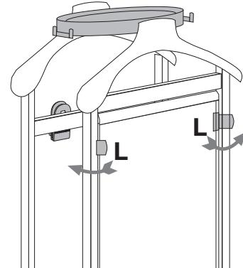
**I** Per aprire il pannello stirapantaloni, spingere le alette (L) in plastica poste ai lati dello stesso. Per richiuderlo, spingerlo fino a chiusura completa.
