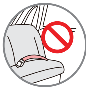
NE PAS utiliser le siège avec une ceinture de sécurité à 2 points
